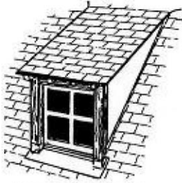
lucarne rampante ou en chien couché
